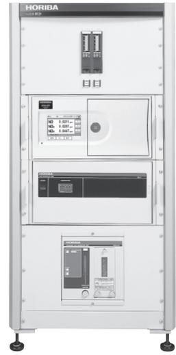
コンバータユニット、測定装置、標準ガス発生器を架台に収納した例（写真はH<sub>2</sub>S計です）
