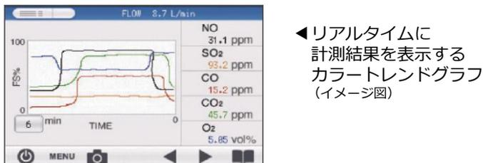
発生ガスの組成を詳細に解析するにはガスクロマトグラフィーなどで測定可能ですが、加熱試験や釘刺し試験にポータブルガス分析計を併用することで、試験中に発生するガスをリアルタイムに計測できます。これにより異常状態の挙動研究や電池交換周期の策定に貢献します。
